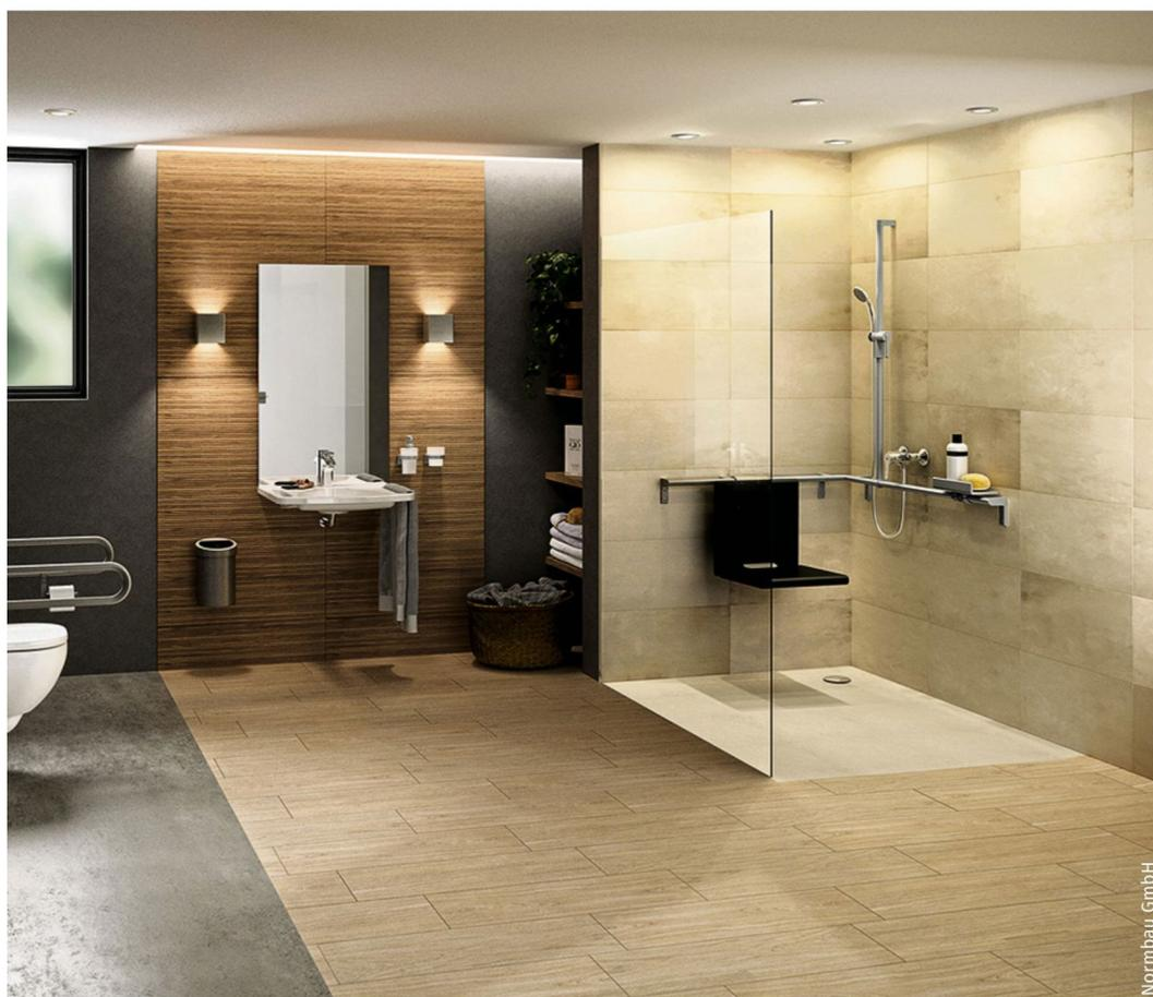
Auch barrierefreie Badezimmer können elegant sein: Hier in der Luxusvariante mit Spiegel in Sitzhöhe, unterfahrbarem Waschbecken, Toilette mit Stützhilfen und beidseitigem Zugang sowie einer Dusche mit höhenverstellbarem Duschkopf und Sitzgelegenheit.
